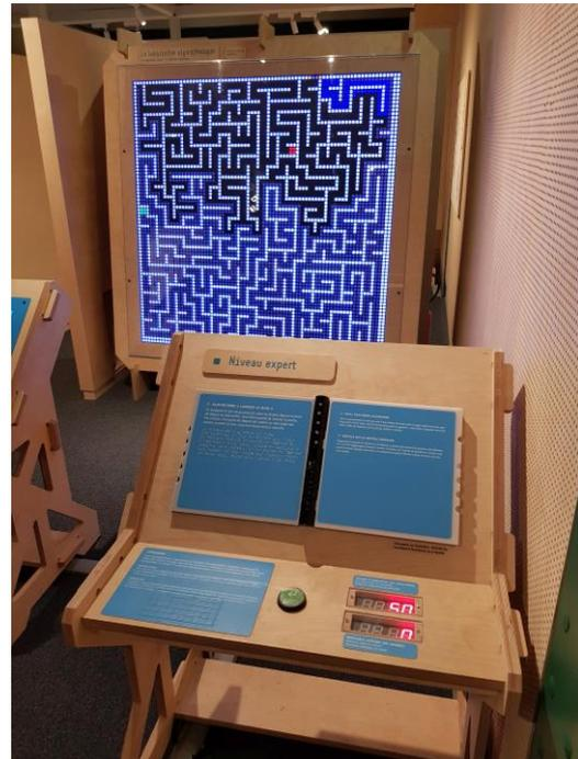
Dans cet élément interactif, on présente aux élèves cinq algorithmes classiques pour résoudre des labyrinthes et on leur demande de les tester puis de les comparer. Pour chaque algorithme, on indique le temps et la mémoire nécessaires pour en sortir.
